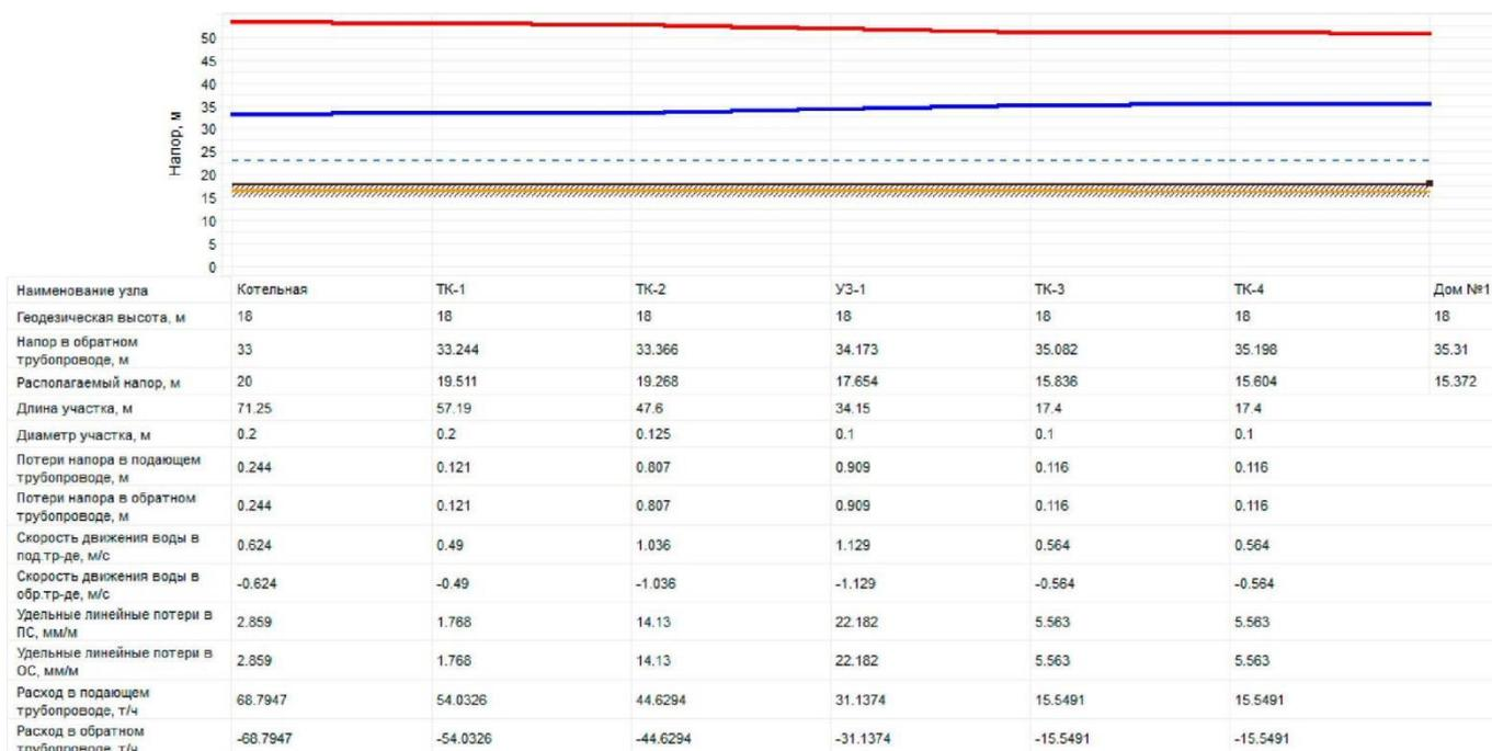
Рисунок 1. Расчетный режим работы тепловых сетей от котельной Севастьяново до дома №1
