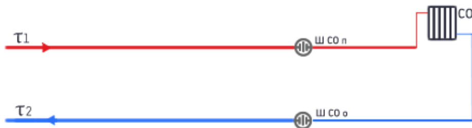
Рисунок 1.11 Схема присоединения потребителей с непосредственным присоединением системы отопления
